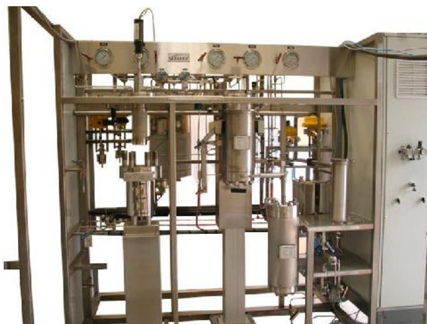
Установка производства наночастиц в сверхкритической воде
