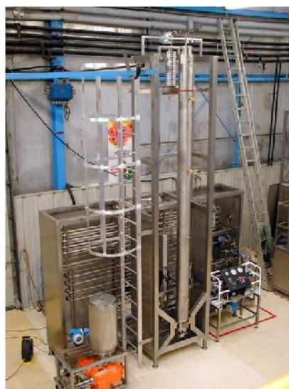
Пожаробезопасная система окисления отходов. Реактор с титановым покрытием.
