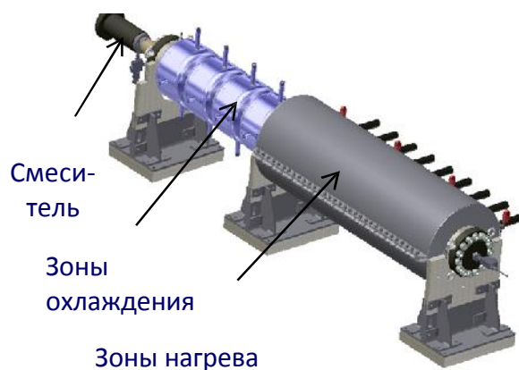
Реактор противоточного окисления со смесителем и внутренним покрытием из титана
